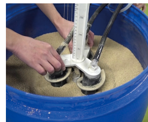
図 3:マルチスクリュー式掘進ロボット試作機(上:外観, 左下:実験環境, 右下:実験の様子)
