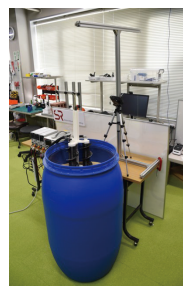
図 3:マルチスクリュー式掘進ロボット試作機(上:外観, 左下:実験環境, 右下:実験の様子)
