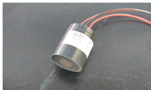
図 1. 2 共振周波数を有する超音波プローブ
