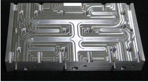
図2 アルミ合金のブロックに切削されたマルチプレクサ導波管回路の写真。サイズは横幅 70mm×奥行 38 mm、組立後の高さは 20 mm である。
