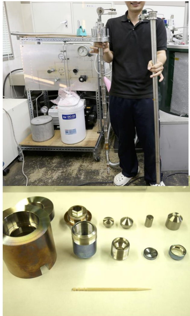
図 2: 本研究期間に開発した、循環式 ^3\text{He} 冷凍 NMR プローブ (上) と小型化超高圧セル (下)。これらの組み合わせにより、世界初の超高圧・極低温 NMR 実験が可能になる。
